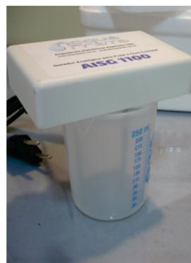
Após conectar os eletrodos ao gerador coloque água até a marca de 250ml e introduza os eletrodos conectados ao gerador AISG1100 no copo Becker.
