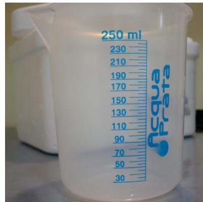
Após encaixar os eletrodos, coloque água no copo Becker até a marca de 250ml. Nunca deixe que o nível da água alcance a parte com solda pois ela é feita de estanho.
