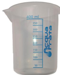
Após encaixar os eletrodos, coloque água no copo Becker até a marca de 400ml. Nunca deixe que o nível da água alcance a parte com solda pois ela é feita de estanho.
