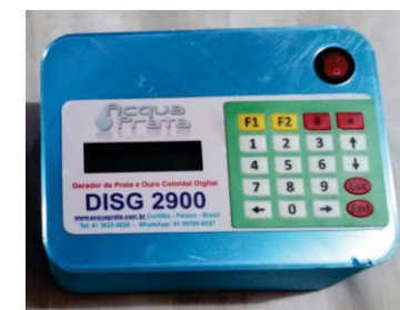
Fig 08. Ligue o Gerador DISG 2900 digite o tempo em minutos conforme tabela. Pressione ENT para iniciar a produção ou ESC para pausar ou ESC de novo para cancelar.
