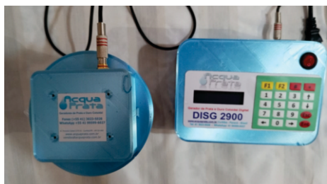
Fig 02. Conecte o cabo ao suporte de eletrodos.
