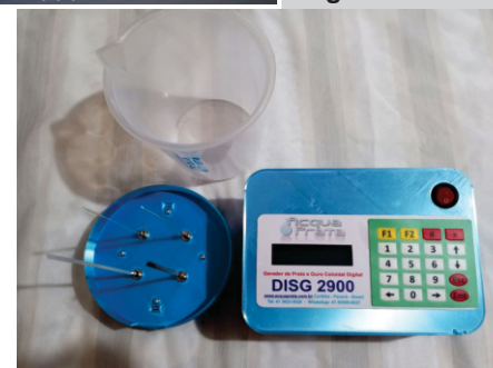
Fig 07. Introduza o suporte de eletrodos com os eletrodos de prata no copo Becker já com a água escolhida.
